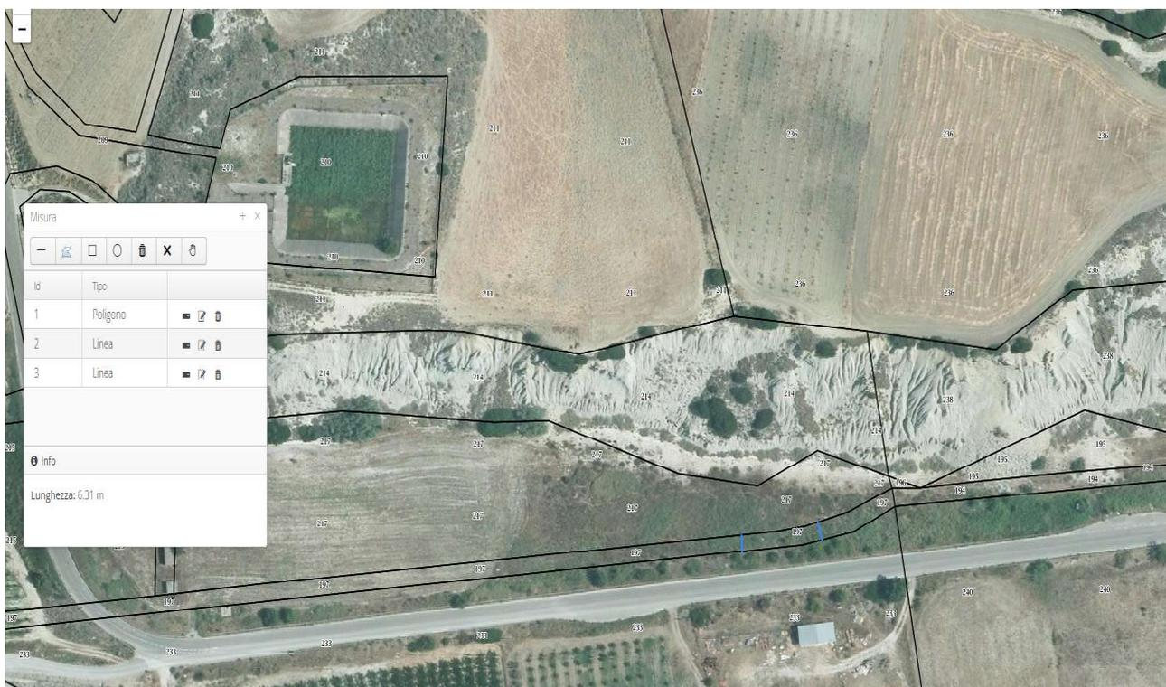
Per un totale di larghezza pari a ml. 21,00 e per una lunghezza corrispondente all'intero tratto da sostituire pari a ml. 3.492,15 e quindi per una superficie totale di  $3.492,15 \times 21 = 73.335,15$  mq. Pertanto si ottiene un riempimento di altezza pari a  $5.082,18 \text{ mc} / 73.335,15 \text{ mq.} = 0,069 \text{ m.} = \mathbf{7 \text{ cm.}}$
