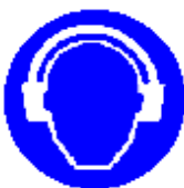
Protezione obbligatoria dell'udito Lavoro con macchine operatrici
