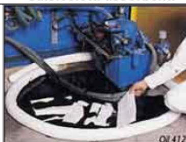
*Per il contenimento delle perdite di olio o di altre sostanze liquide, hanno anch'essi un elevato potere assorbente (fino a 20 volte il loro peso)*
